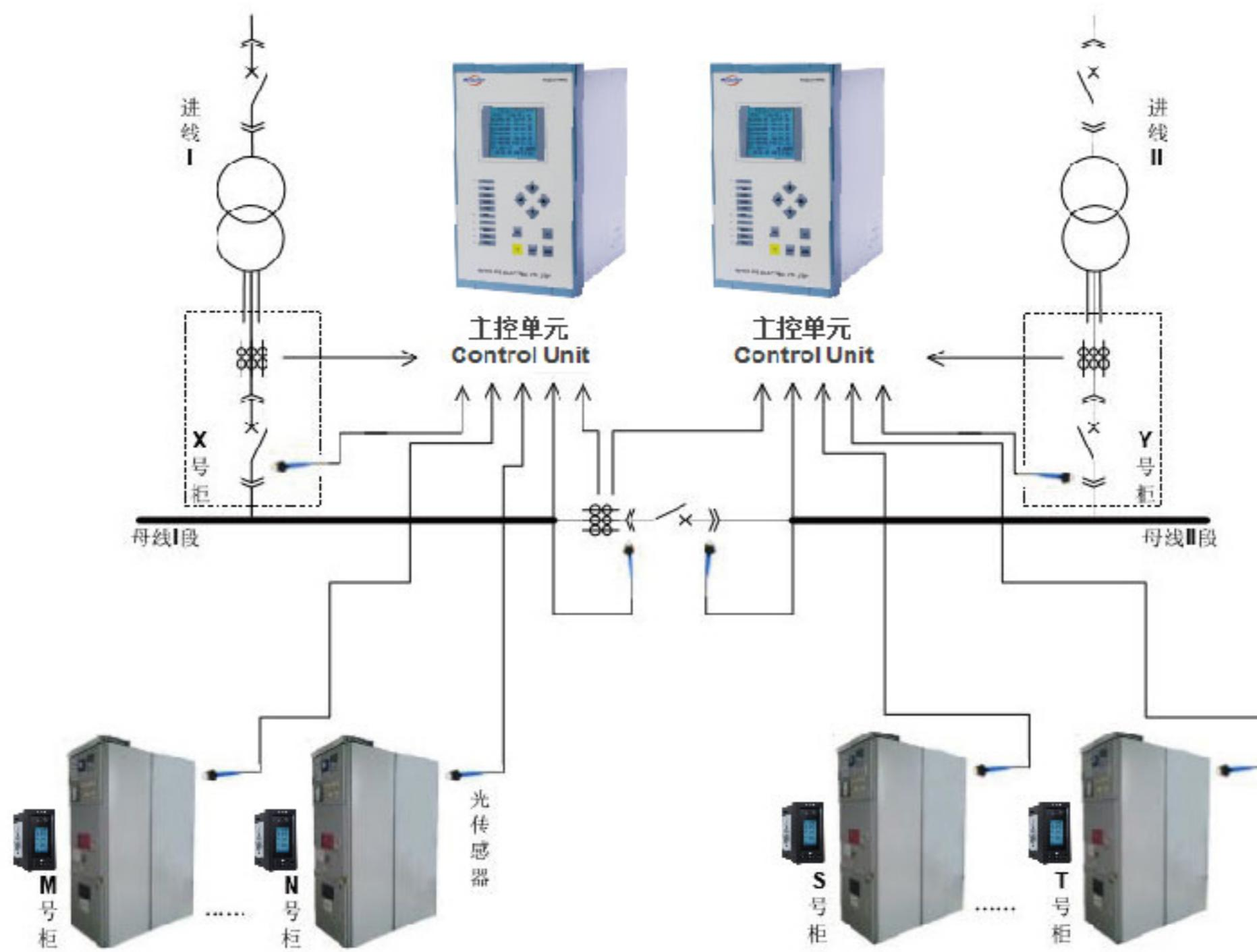
由于配置模块化，系统适合于各种不同场合的电弧光保护应用，可组成从只有一个主控单元的简单系统，到包含多个单元能用于选择性电弧光保护的复杂系统。
