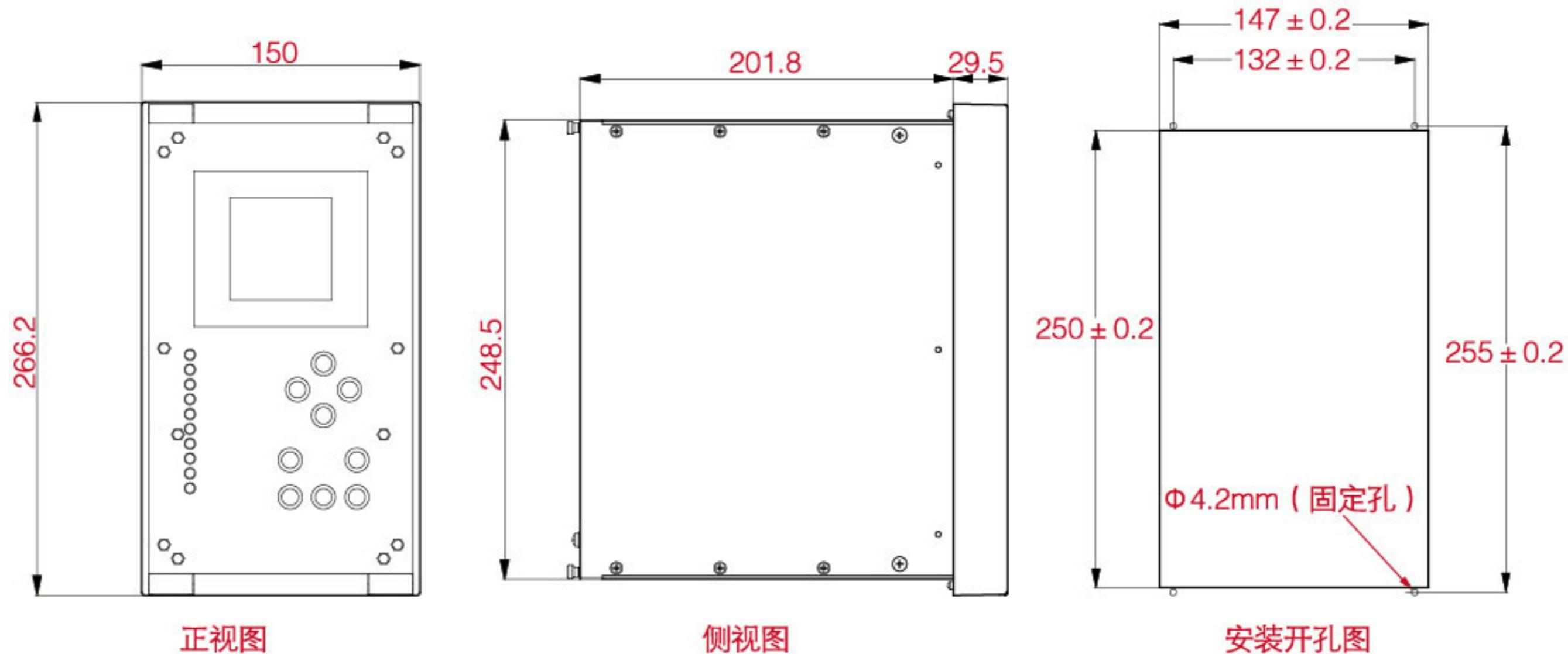
中高压母线弧光保护装置KSL101ARC ( H型 ) 尺寸图
