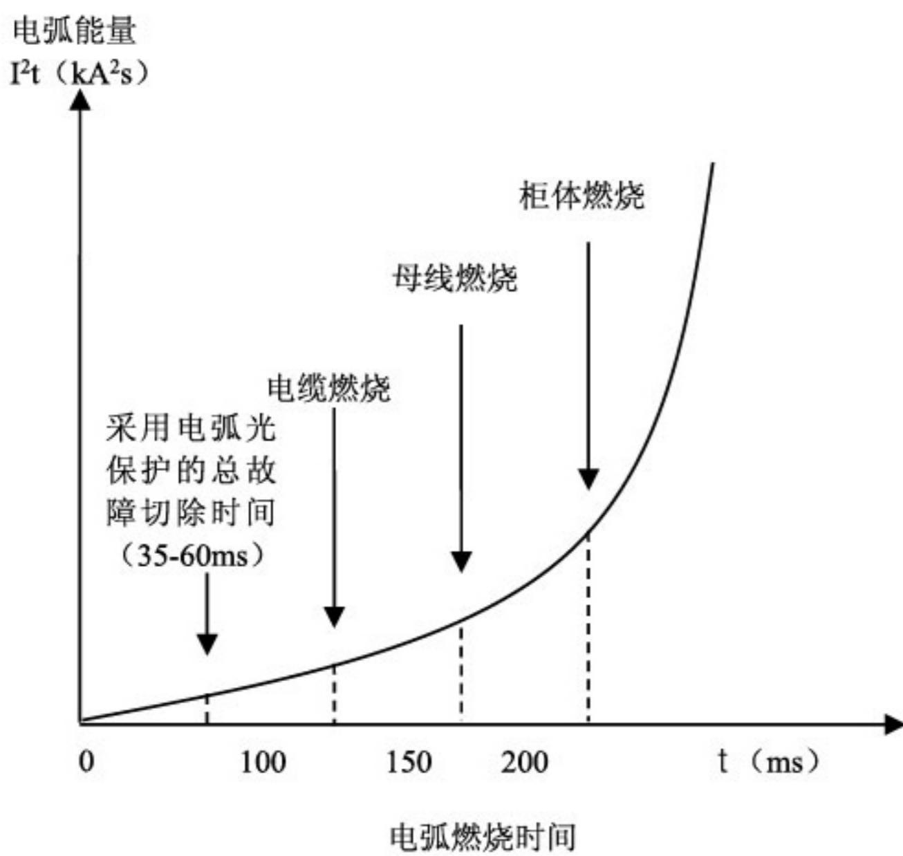
图一 电弧光的危害示意图
