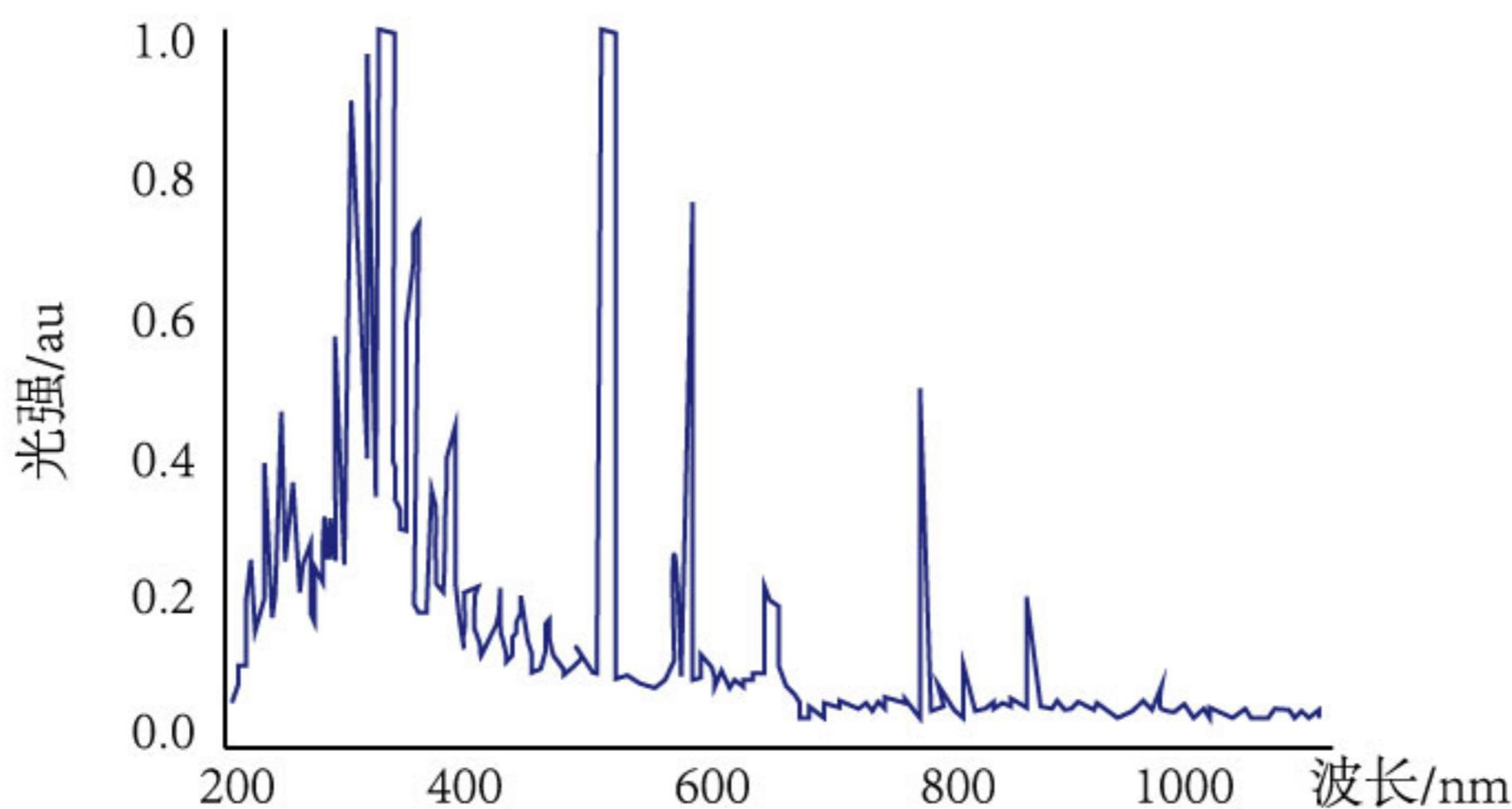
图三 铜电极电弧光光谱图
