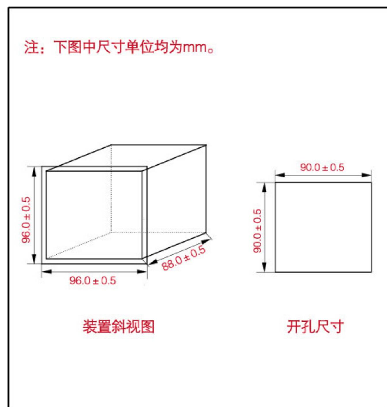
低压母线弧光保护装置
